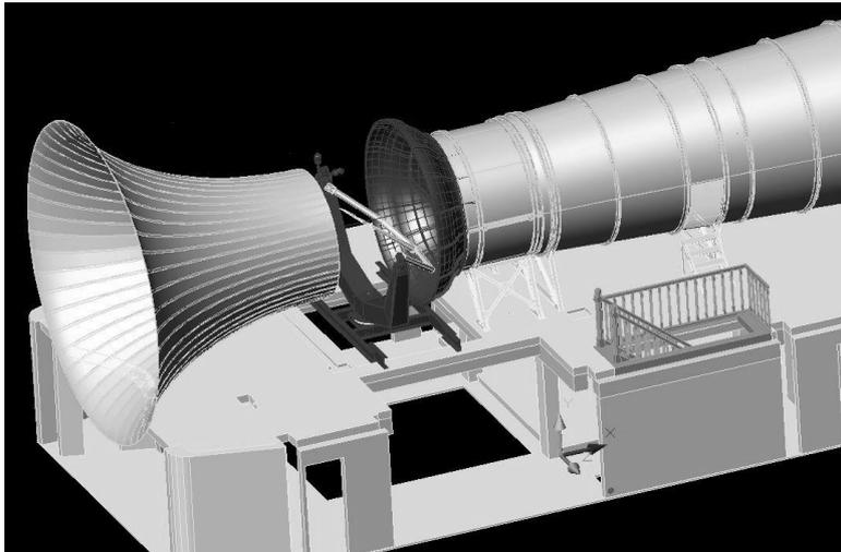
Figure 11: L1 wind tunnel configuration « open test section » and « PQR » rig
